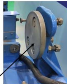
检查并清洁吸合圆盘和电磁铁的接触面
